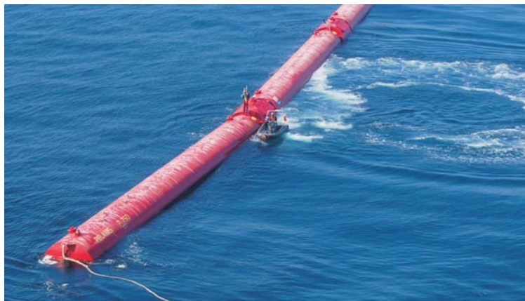
Central de récupération de l'énergie des vagues.
