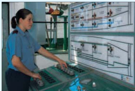
1MAR CM Elisete Descalço junto ao painel de controlo das válvulas dos tanques de combustível (NRP "Bérrio").
