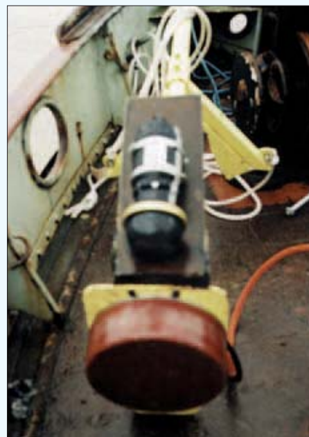
Pormenor do transdutor da sonda multifeixe.
