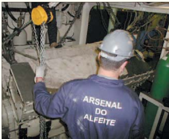
Movimentação do bloco do motor no interior do hangar.
