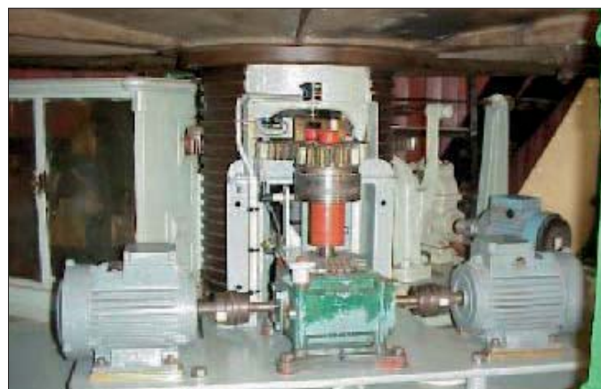
Sistema de rotação do Farol.
