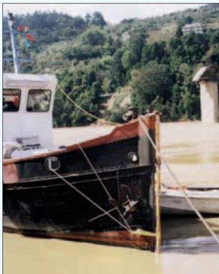
Pormenor da montagem do transdutor da sonda na embarcação "Fuinha".
