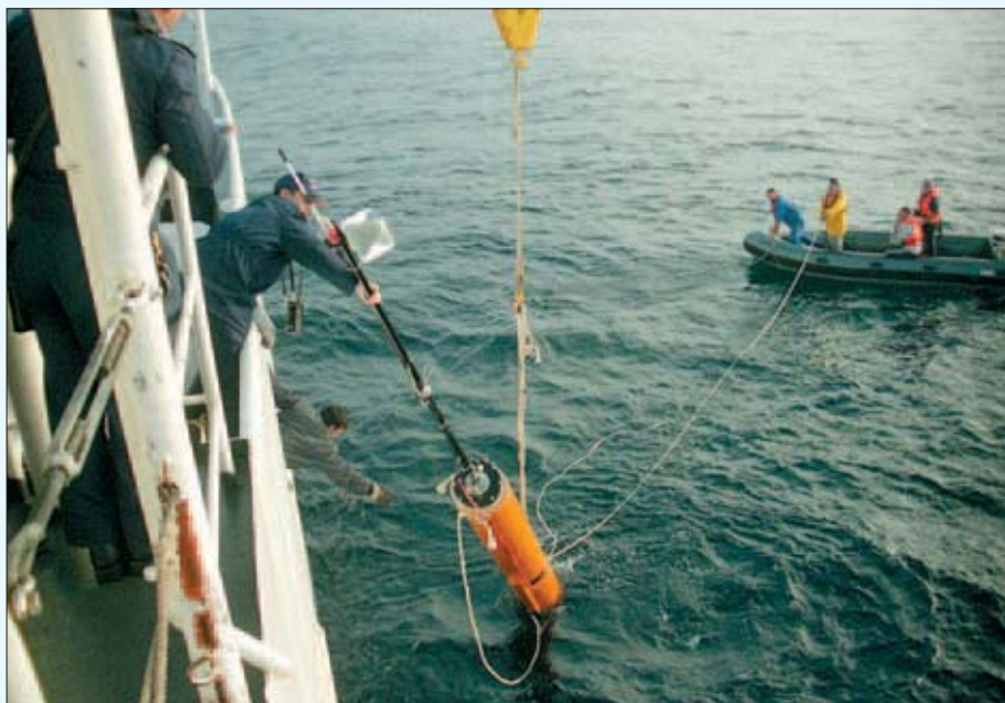
Colocação na água da bóia transmissora das cadeias de hidrofones ULVA e HFA.
