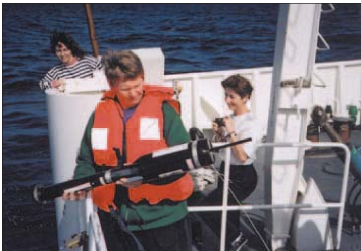
Fig. 4 – Lançamento de um perfilador de corrente descartável (XCP) realizado a bordo do NRP “D. Carlos I”, durante a campanha MEDTOP 01/1 (19/02/01-01/03/01). Este aparelho, à medida que vai penetrando na coluna de água, envia para bordo os dados que vai medindo (componentes zonal e meridional da corrente e temperatura) através de um sistema rádio que fica à superfície no local onde o aparelho foi lançado.
