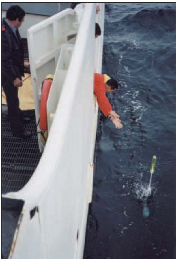
Fig. 5 – Lançamento de um flutuador de profundidade RAFOS, realizado a bordo do NRP “D. Carlos I”, durante a campanha MEDTOP 01/1 (19/02/01-01/03/01). O trajecto de cada flutuador é seguido acusticamente, i.e., o flutuador vai recebendo os sinais acústicos emitidos por duas ou mais fontes sonoras colocadas previamente em amarrações. Quando o flutuador termina a missão e volta à superfície, toda a informação nele acumulada (a qual inclui, para além dos registos de recepção dos sinais acústicos, registos da temperatura e da pressão medidas ao longo do trajecto) é enviada para os satélites do sistema de informação ARGOS, o qual a recebe e dirige para os respectivos utilizadores.
