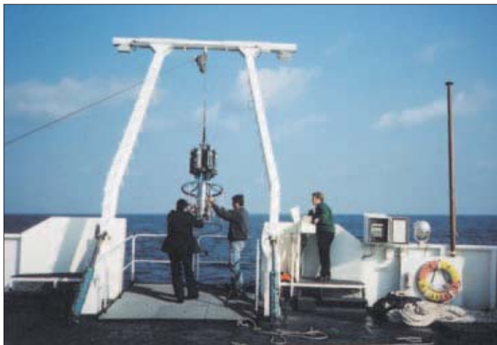
Fig. 3 – Operação de lançamento à água da sonda CTD, a bordo do NRP “D. Carlos I”, durante a campanha MEDTOP 01/1 (19/02/01-01/03/01). Esta sonda, à medida que afunda, vai enviando para o sistema de aquisição a bordo os dados de temperatura, condutividade e pressão ao longo da coluna de água. A partir destes valores pode-se calcular a salinidade aos vários níveis.
