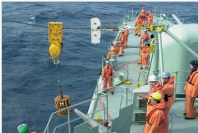
Transferência de sólidos pelo método "Heavy jack stay" (pela primeira vez efectuado por navios da Marinha Portuguesa).
