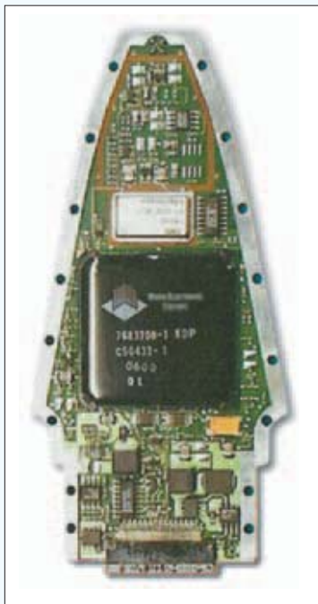
Fig. 2 - Microreceptor GPS para instalação numa bomba "inteligente".
