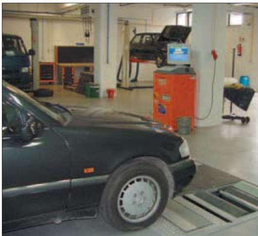
Máquina de testes de suspensão, trenómetro e ripómetro.
