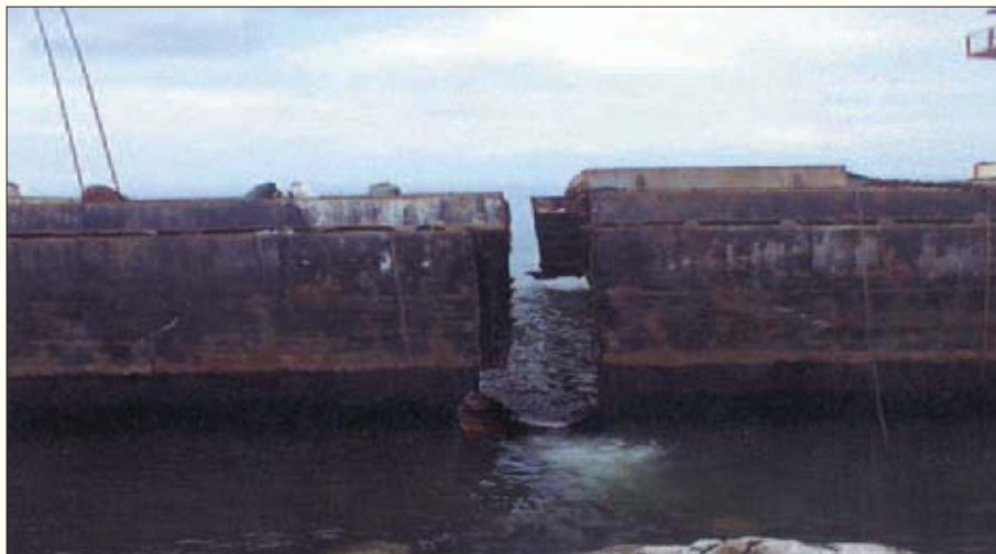
Estado do casco após o corte em duas secções.
