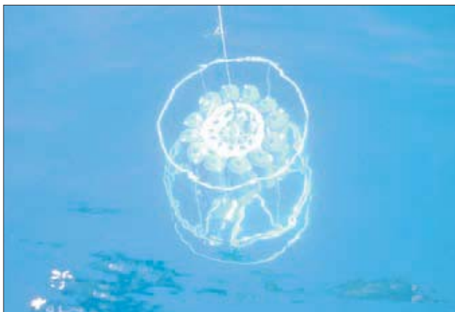
Um CTD/Rosette a ser içado após uma descida a 3000 metros de profundidade.
