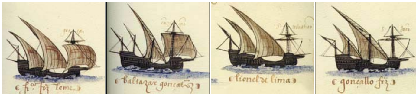
Caravelas redondas do Livro das Armadas pertencentes à armada de D. Pedro de Castel Branco (1533), em mareações diversas. Note-se a existência do botaló.
