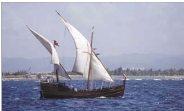
A caravela Boa Esperança navegando à vela ao largo de Porto Rico. Destaque para o botaló à popa onde faz retorno a pouca caçada escota da mezena.
