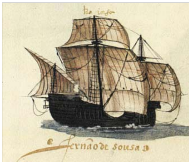
Nau de Fernão de Sousa do Livro das Armadas. Atente-se nas monetas e nos braços dos papa-figos e da gávea.
