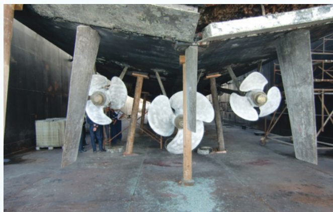
O NRP Tejo durante a fase de limpeza das obras vivas, em 24SET15
