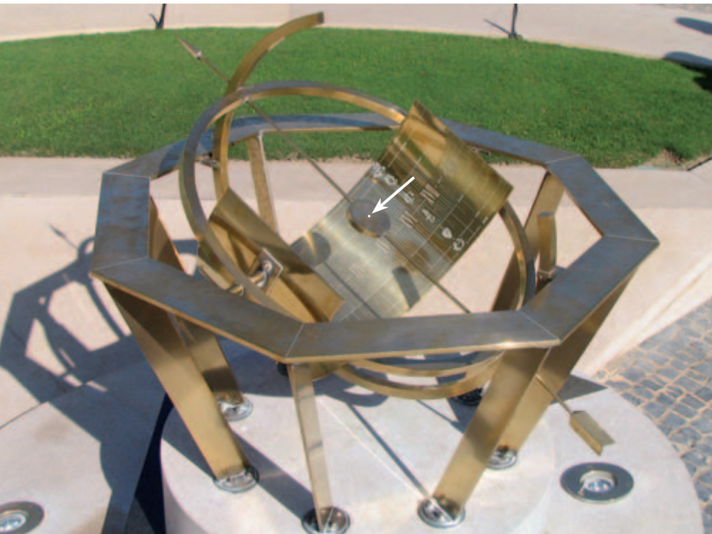
Relógio armilar situado no Hotel Pine Cliffs – Algarve. Basicamente um relógio equatorial, onde o nodo do gnómon é um orifício que produz a sombra (indicado pela seta na figura), que é projetada para um setor de cilindro, onde estão inscritas as linhas horárias e as curvas (neste caso semi-círculos) de declinação.
