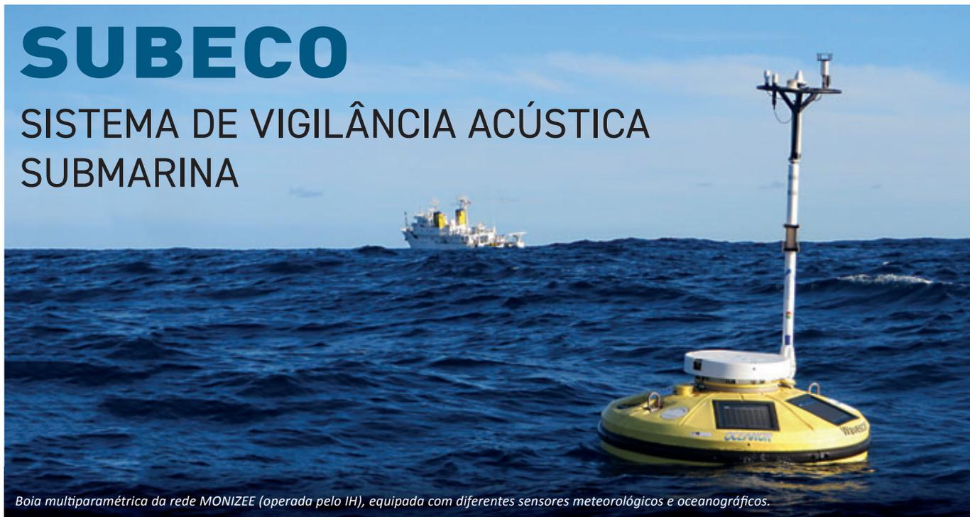
Boia multiparamétrica da rede MONIZEE (operada pelo IH), equipada com diferentes sensores meteorológicos e oceanográficos.
